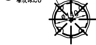
支柱绝缘子顶部安装尺寸
